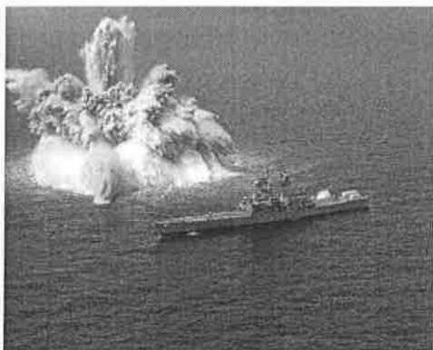
รูปที่ 12 แรง Shock ที่เกิดขึ้นเนื่องจากการระเบิดใต้น้ำ [6.8]
